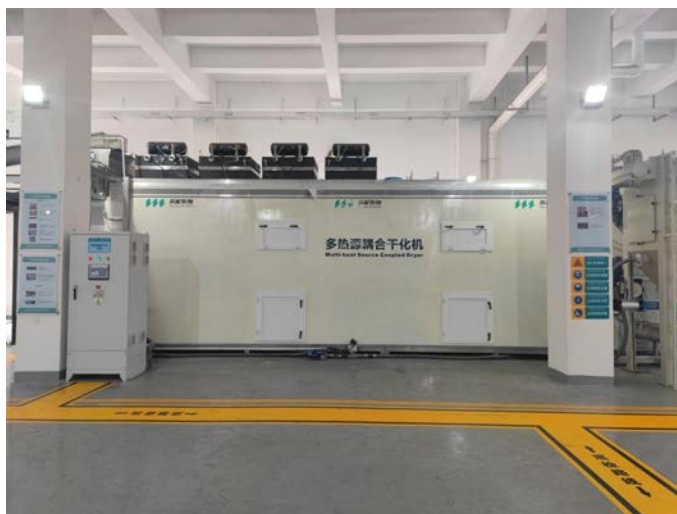
图 5.2 多能源耦合低温带式干化系统
