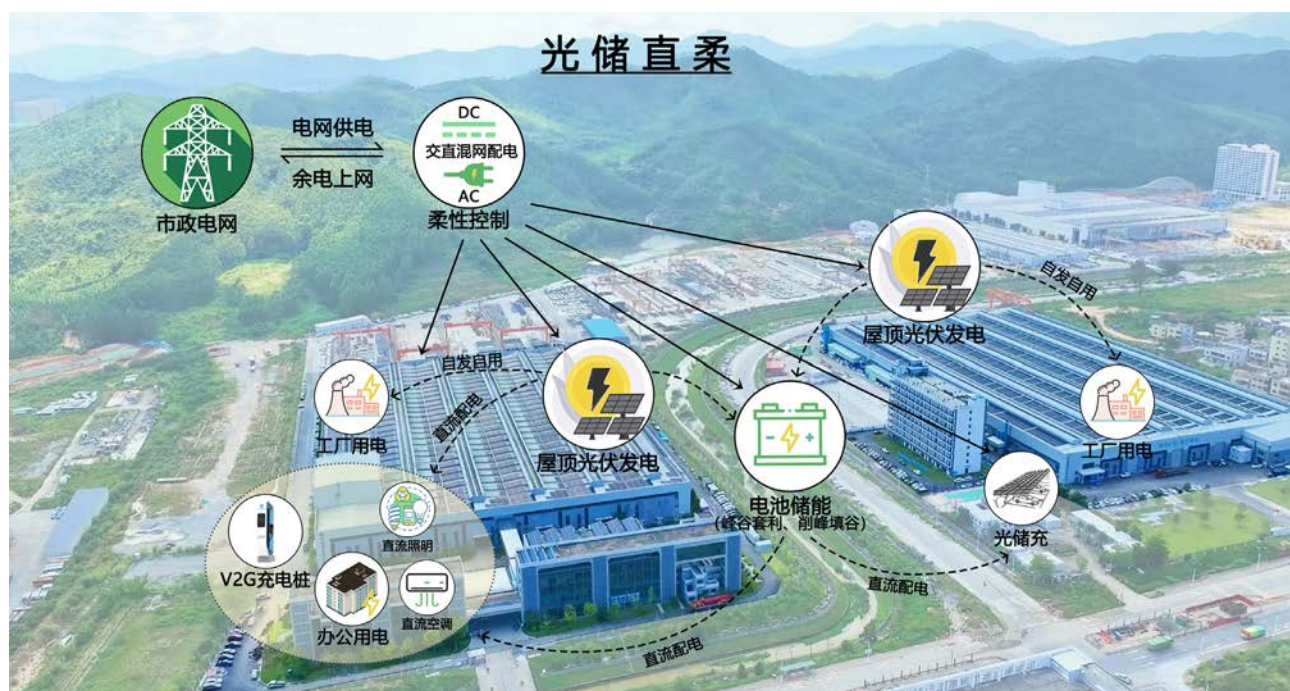
图 2.2 光储直柔原理示意图
