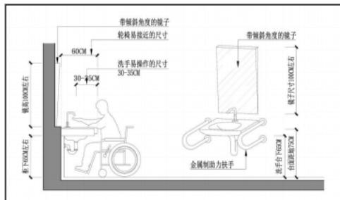
图 19 无障碍洗手盆设置示意图
