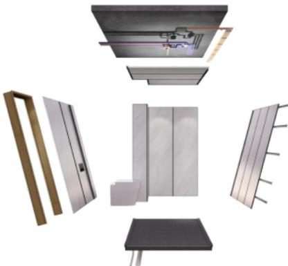
图 34 装配式卫生间分解示意图
