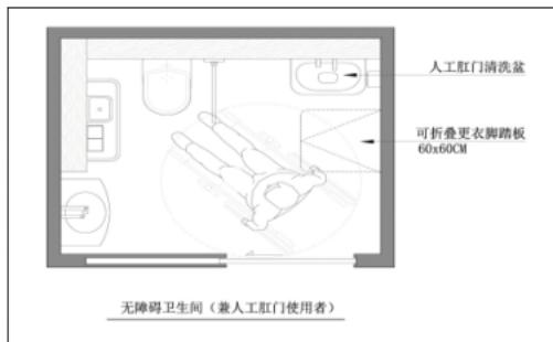
图32 人工肛门清洗盆示意图
