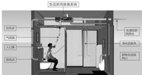
图1 进排鼻三点一线无混旋换气法示意图
