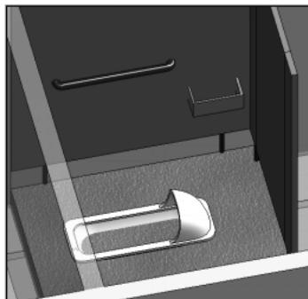
图3 厕位间内设置助力扶手及大小便样品置物台示意图
