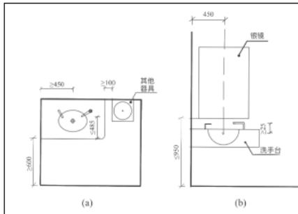
图 26 洗手区域设施布置示意图
