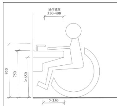
图 27 无障碍洗手台盆设置示意图
