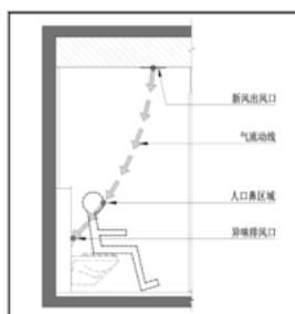
图 23 进风口—人口鼻—排风口示意图
