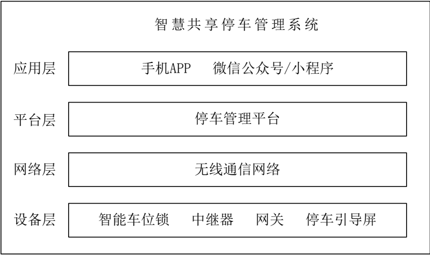
图 1 智慧共享停车管理系统架构图
